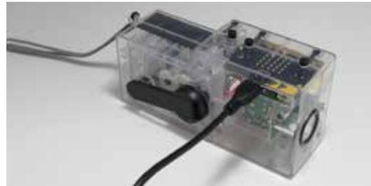
②マイクロビット基板を組立てて、ライトに組込みます。キャビネットの外からマイクロUSBケーブルを接続できるほか、マイクロビットのリセットボタンを押すこともできます。
