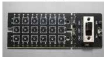
40-131Cでは、リバーシブル基板をスイッチ基板として使用しています。部品面には、電子回路を設計して部品をはんだづけすることができます。
