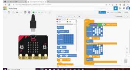
①Tinkercadでマイクロビットのプログラムを設計します。
