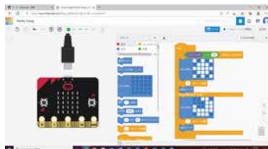
①Tinkercadでマイクロビットのプログラムを設計します。
