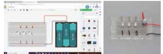
①Tinkercadで回路を設計し、別売の透明ブレッドボードを使って動作実験をします。
