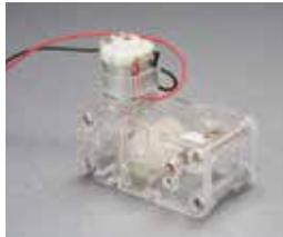
「L型シングル3速ギアボックス」を組立てて、モータの回転がギアを通じてシャフトに伝わる仕組みについて学習します。
